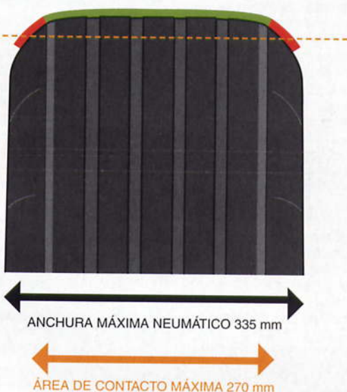
La línea de puntos muestra cómo se ensancha la banda de rodadura con el desgaste.
