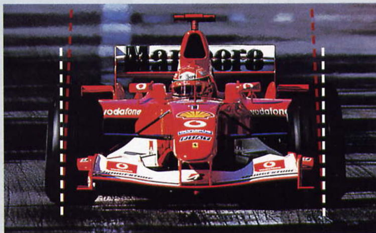
Las líneas de puntos rojas indican el ángulo de caída negativa que requieren los neumáticos Bridgestone. Los Michelin van derechos (líneas blancas) y maximizan el área de contacto.
