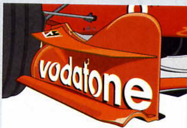
El elemento inferior de la deriva lateral impide turbulencias alrededor de las ruedas.
