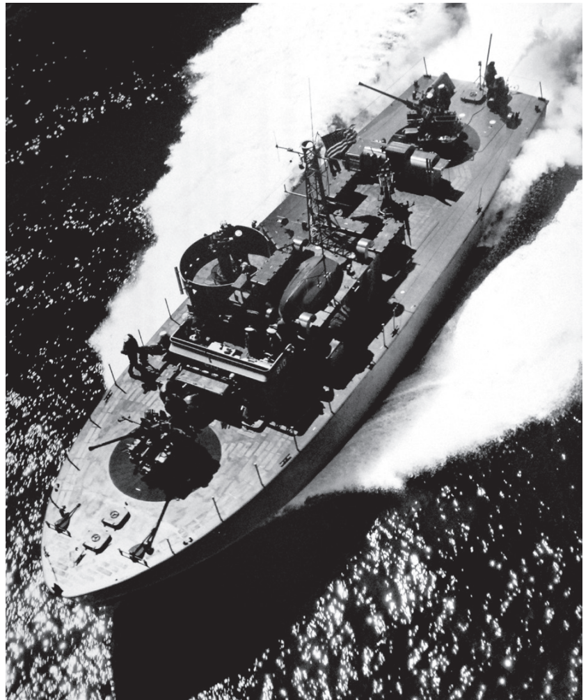
▲ Deux canons de 40 mm, quatre de 20, le PT Boat 810 est un vrai porc-épic, difficile à touché en évolutions serrées à près de 40 nœuds. Seule ombre au tableau, ces embarcations ultrapuissantes ne sont presque pas blindées.
