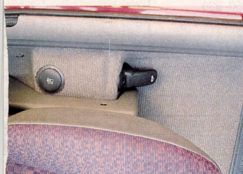
A vezetőülés mellett a csomagtér távnyitója és a biztonsági benzinszelep gombja
