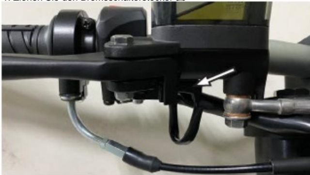
2. Entfernen Sie die Befestigungsschraube des Vorderradbremsszylinders.
