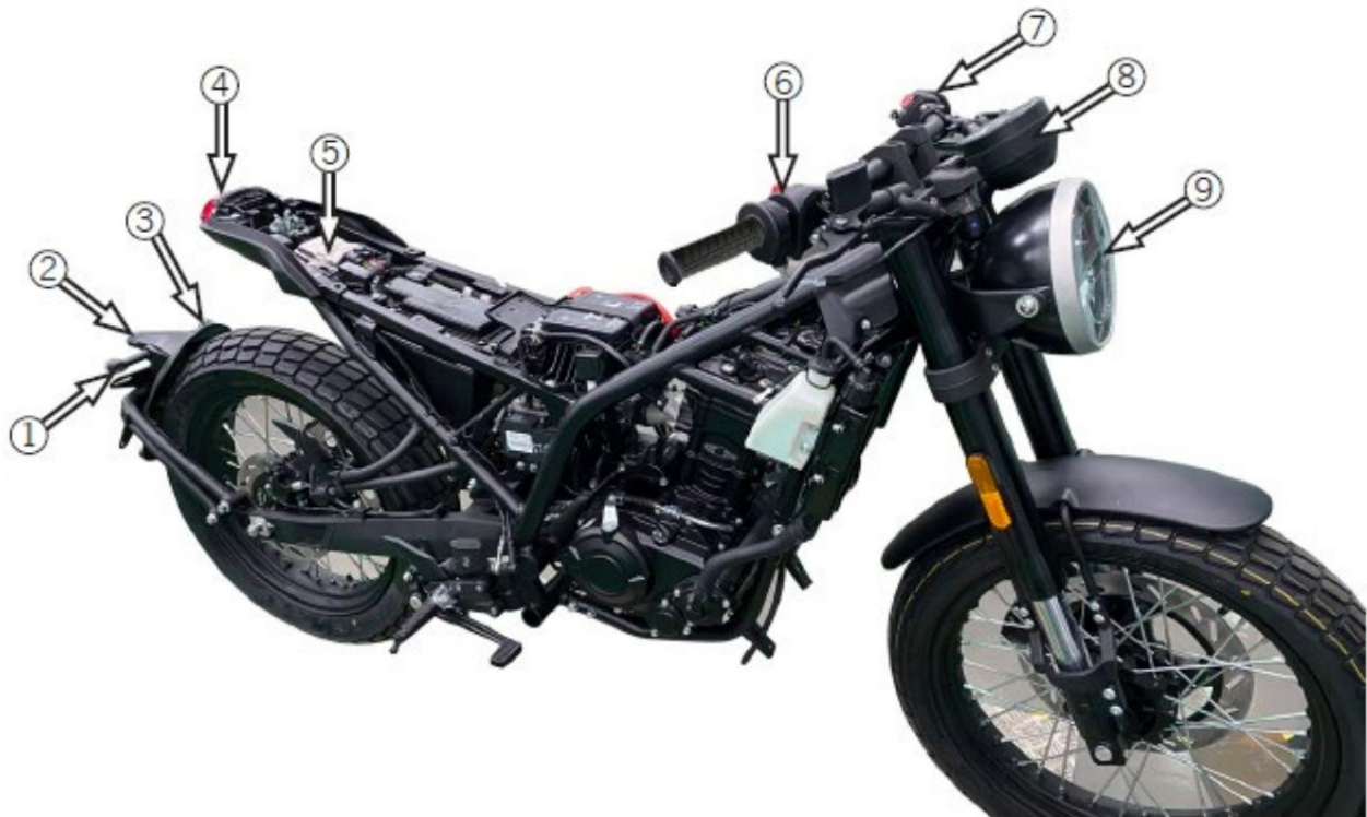
1 Blinkleuchte hinten rechts, 2 Kennzeichenleuchte hinten, 3 Blinkleuchte hinten links, 4 Kombi-Rückleuchte, 5 ECU, 6 rechter Kombinationsschalter, 7 linker Kombinationsschalter, 8 Messgerät, 9 Scheinwerfer
