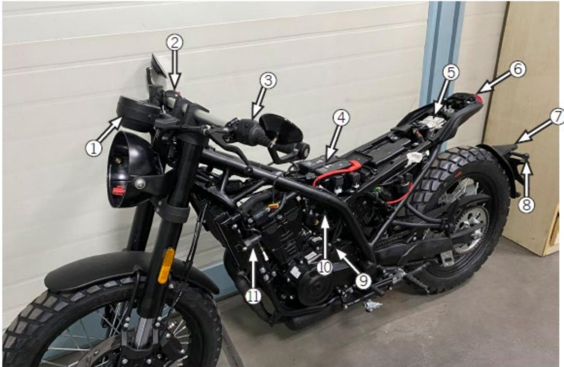
1 Instrument, 2 Rechter Kombischalter, 3 Linker Kombischalter, 4 Batterie, 5 ECU, 6 Kombi-Rückleuchte, 7 Kennzeichenleuchte hinten, 8 Blinkerleuchte hinten links, 9 Sensor, 10 Drei-in-Eins-Sensor, 11 Wassertempersensur
