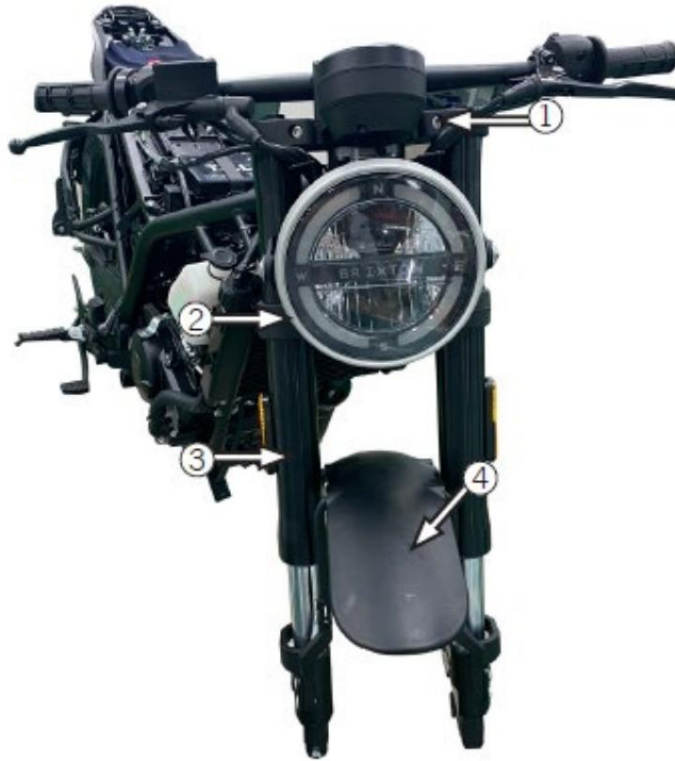
1 obere Stoßdämpferschraube, 2 untere Stoßdämpferschraube, 3 vorderer Stoßdämpfer, 4 vorderer Kotflügel
