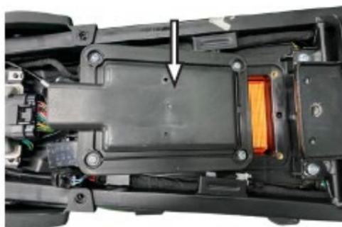
Nehmen Sie die Luftfilterabdeckung heraus
