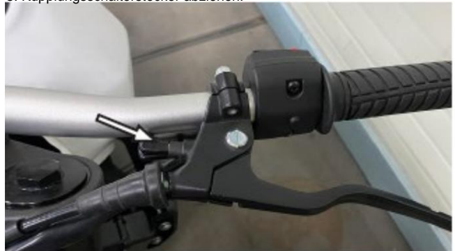
6. Entfernen Sie die Kupplungsgriffschraube.
