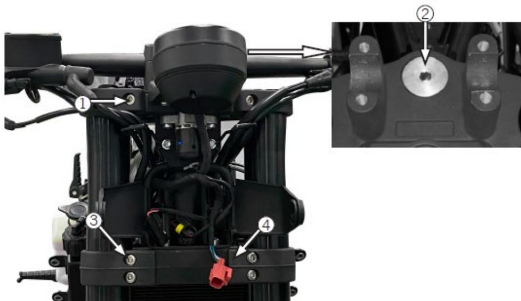
1 oberer Dämpfungsbolzen, 2 Lenksäulen-Arretierbolzen, 3 unterer Dämpfungsbolzen, 4 Lenksäulenkombination
