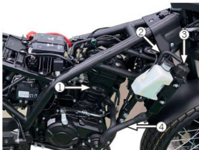
1 Motor, 2 Kurzkreisschlauch/Wasserrohr, 3 Wassertankabdeckung, 4 Wasserauslassschlauch/Wasserrohr, 5 Kühler, 6 Wasserzulaufrohr, 7 Thermostat, 8 Temperatursensor
