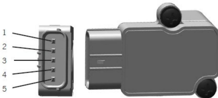
1 Einlassdrucksignal, 2 5-V-Referenzspannung, 3 5-V-Referenzspannungserdung, 4 Drosselklappenpositionssignal, 5 Einlasstemperaturssignal
