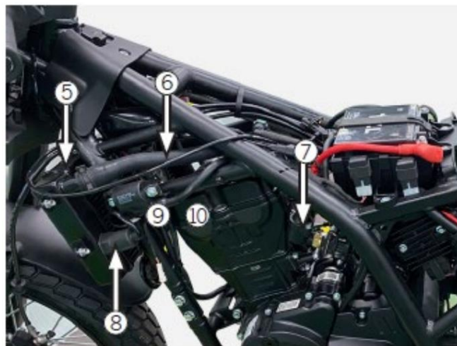
1 Motor, 2 Kurzkreisschlauch/Wasserrohr, 3 Wassertankabdeckung, 4 Wasserauslassschlauch/Wasserrohr, 5 Kühler, 6 Wasserzulaufrohr, 7 Thermostat, 8 Temperatursensor
