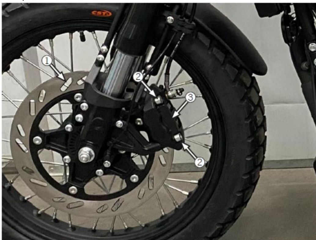
1 Vorderradbremsscheibe, 2 Bremssattelschrauben, 3 Vorderradbremssattel
