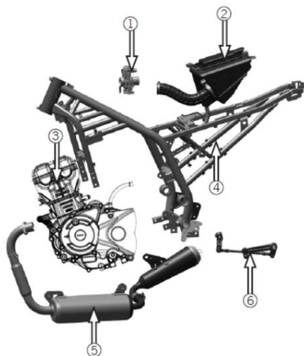
1 Drosselklappengehäuse, 2 Luftfilter, 3 Motor, 4 Rahmen, 5 Schalldämpfer, 6 Getriebepedal
