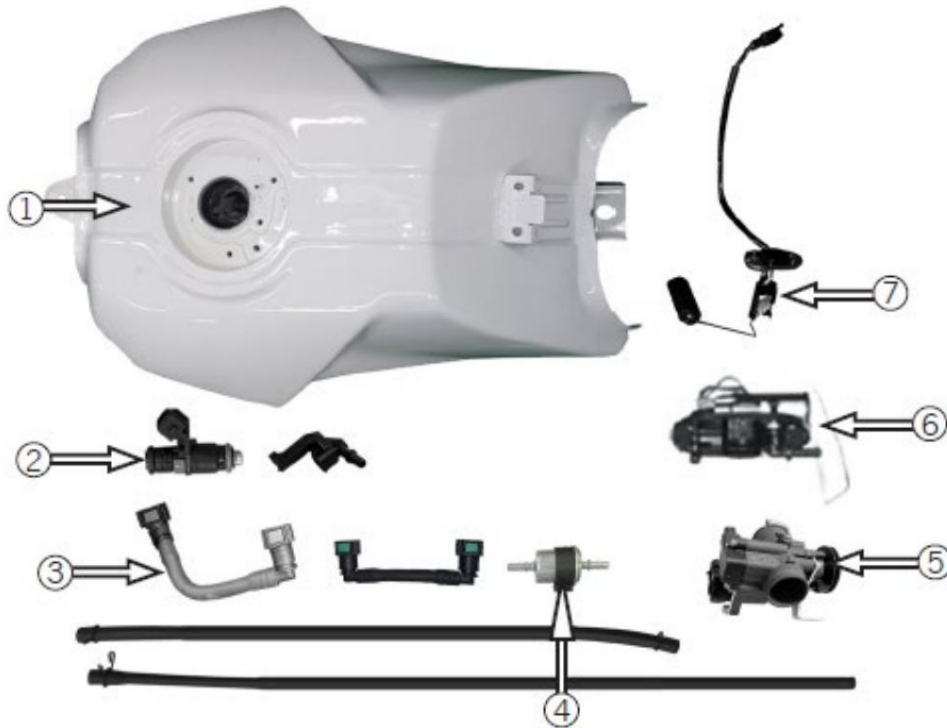
1 Kraftstofftank, 2 Kraftstoffeinspritzventil, 3 Hochdruckrohr, 4 Luftfilter, 5 Ventilkörper, 6 Kraftstoffpumpe, 7 Kraftstoffsensoren
