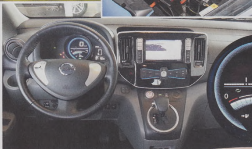
Zongoralakk- és fémhatású betétekkel próbál érdekesebbnek látszani a vezetőhely. A műszeregységen a töltöttség és a hatótáv
