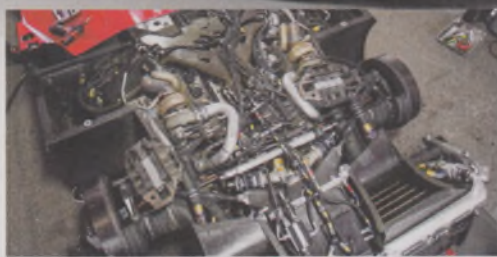
A Nissan gépe a 2 MJ-os divízióban indul: a V6-os elől, a villanymotor hátul hajt
