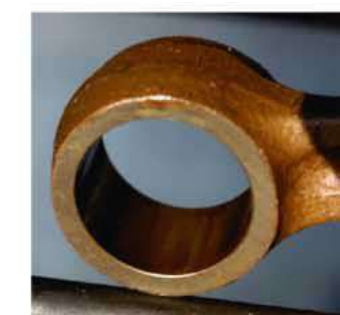
Ein noch leicht veröltes, aber unbeschädigtes Pleuelauge. Der Durchmesser beträgt beim 200er Motor 16,0 mm.
