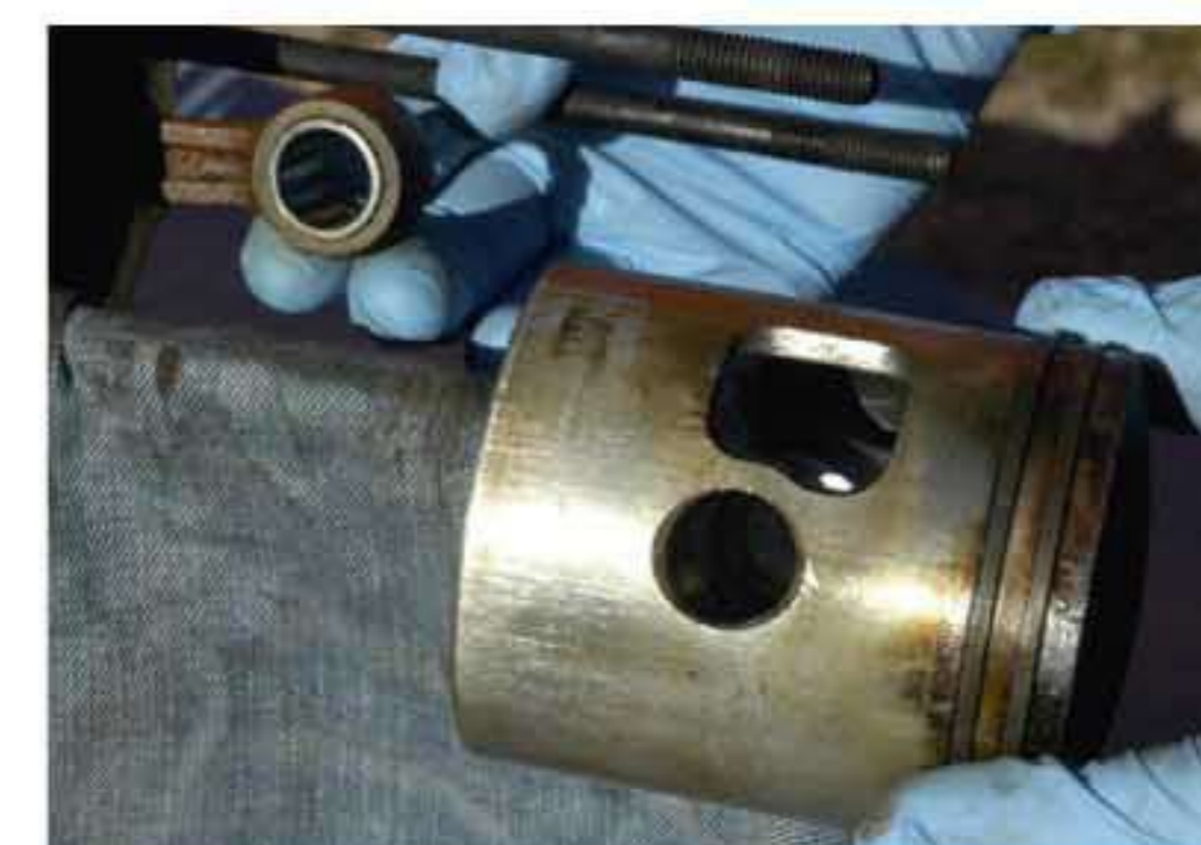
Oben: der ausgebaute Bolzen neben dem lose abgelegten Kolben. Mitte: Kolben und Pleuelauge mit noch eingebautem Nadellager. Unten links/rechts: das ausgebaute Nadellager; für eine mögliche Wiederverwendung wird das Lager markiert.
