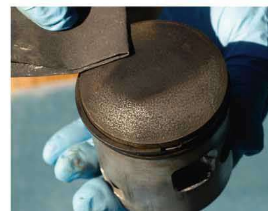
Links: Entfernen von Ölkohle und Ablagerungen vom Kolbenboden.
