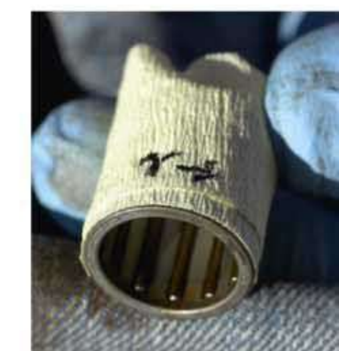
Oben: der ausgebaute Bolzen neben dem lose abgelegten Kolben. Mitte: Kolben und Pleuelauge mit noch eingebautem Nadellager. Unten links/rechts: das ausgebaute Nadellager; für eine mögliche Wiederverwendung wird das Lager markiert.
