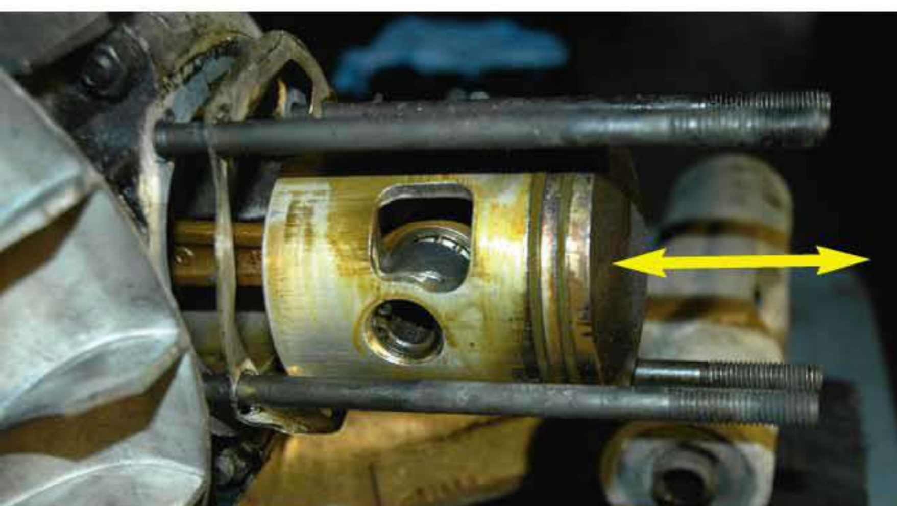
Oben und rechts: der överschmierte und verkrustete Kolben eines zur Restaurierung anstehenden Motors. Gut zu sehen: leichte Riefen und Brandspuren sowie die leicht vorgezogene Zylinder-Fußdichtung. Pfeile: Vor dem Ausbau wird durch ruckartiges Ziehen in Längs- und Querrichtung geprüft, ob Pleuelauge, Kolbenbolzen und Pleuelfuß Spiel haben.
