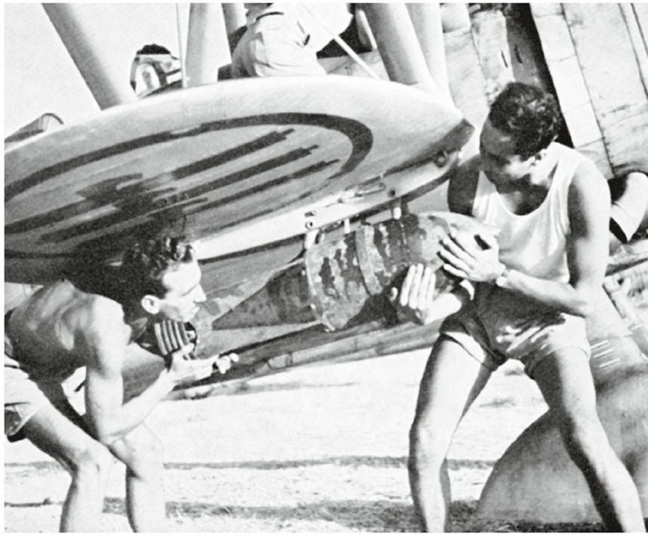
▲ Fixation d'une bombe de 50 kg sous l'aile d'un CR.42 AS « Bombe Alari ». Jusqu'à l'armistice de 1943, ce biplan pallie tant bien que mal les carences de la Regia Aeronautica.
