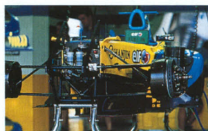
V kobilica - prednji donji ovjesi su pričvršćeni na trokutastu kobilicu
