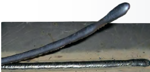
Slikoviti prikaz samoodvajajuće šljake prilikom zavarivanja Castolin 4213 elektrodom
