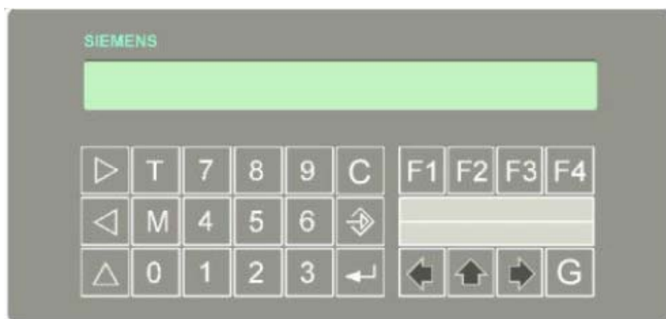
Fig.3: Terminal OT10 för inställning av tågdata
