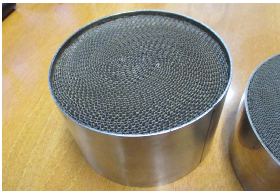
Спортивный катализатор. Видно, что сота имеет довольно большой размер.
