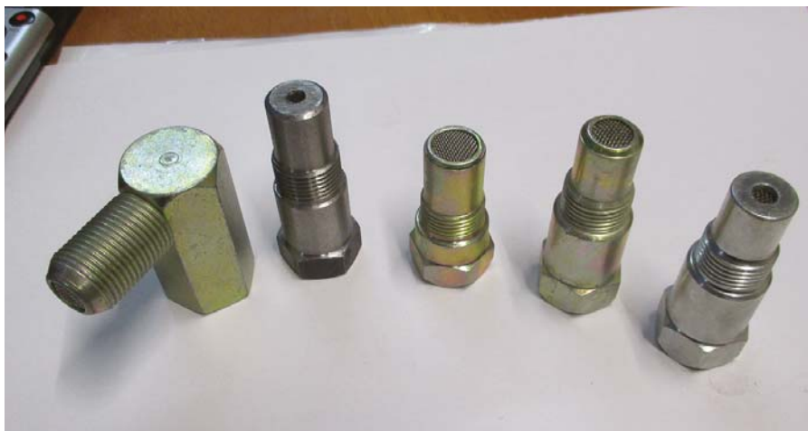
Обманки старого типа – проставки под лямбда-зонд, создающие изолированное пространство между датчиком и кусочком катализатора.
