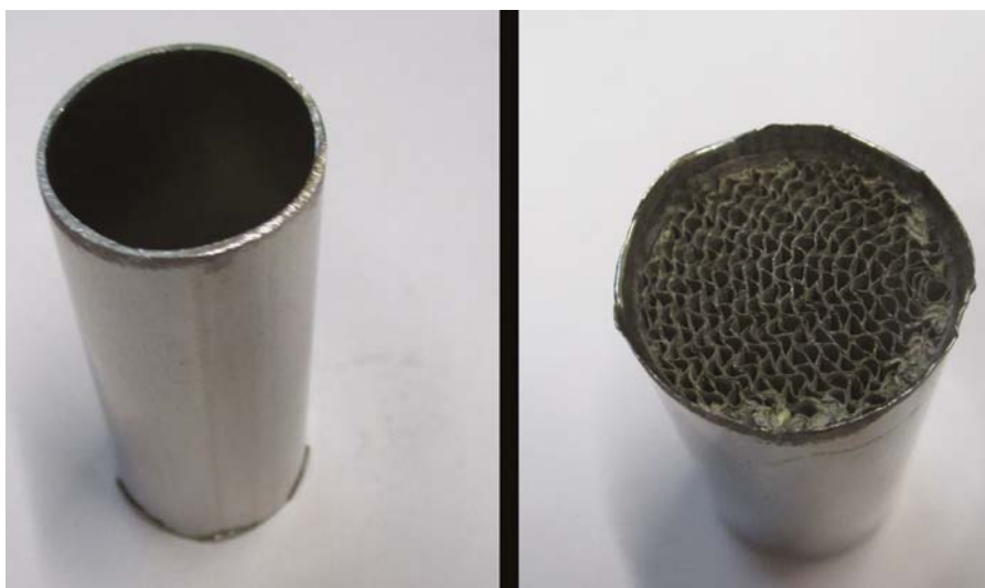
Обманка нового типа, обеспечивающая циркуляцию выхлопных газов
