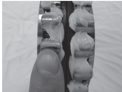
圖8-6 保持器外徑面有滑脂坨，盡量用手指將滑脂塗勻
