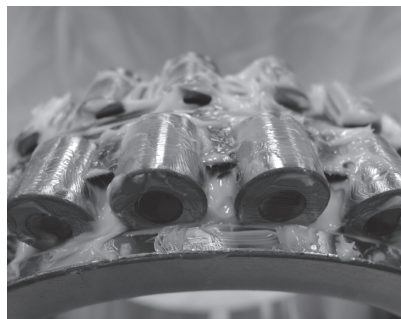
圖8-6 保持器外徑面有滑脂坨，盡量用手指將滑脂塗勻
