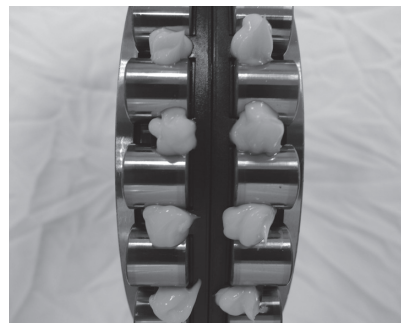
圖8-5 在滾子表面塗上滑脂時，用指尖轉動滾子，使滑脂分布在內環側
