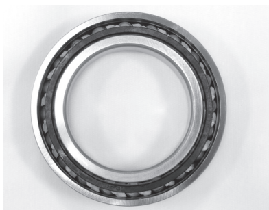
圖8-3 用手旋轉使滑脂完全分布在內環側
