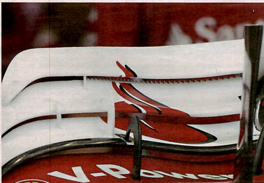
Ferrari zeigt Zähne: An den spitzen Kanten sollen Wirbel entstehen, die die Strömung verbessern
