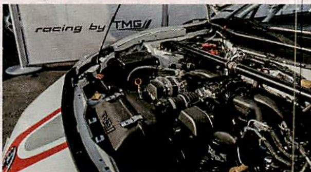
Kleine Drehorgel: Der Vierzylinder-Saug-Boxer leistet 212 PS
