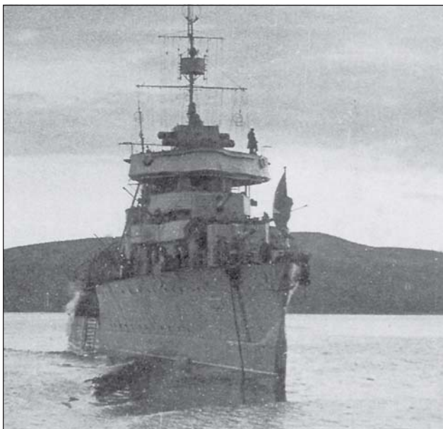
Лидер «Баку» перед уходом на Север. Июль 1942 г. Видна «ледовая шуба», установленная для защиты ватерлинии
