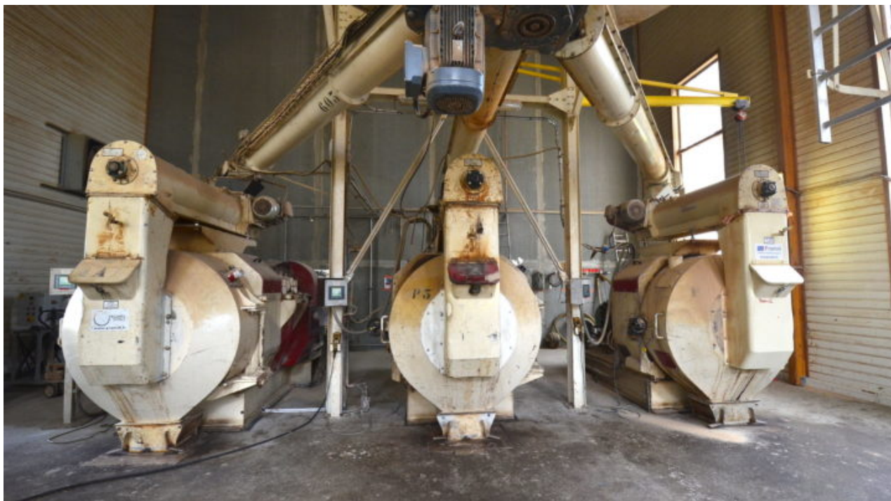
Trois des six presses à granulés de Piveteau à Sainte-Florence, photo Frédéric Douard
