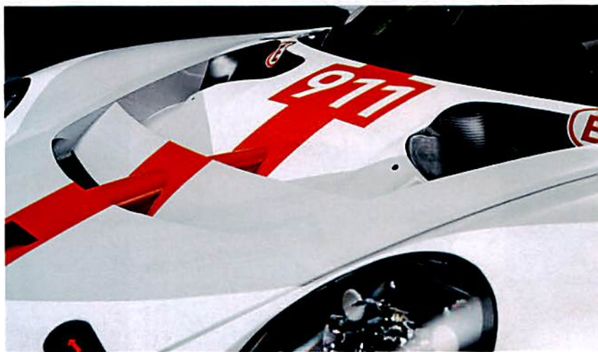
Die Durchströmung und Ausleitung der Luft an der vorderen Haube dient dazu, noch mehr Abtrieb zu generieren und die Kühlung zu verbessern
