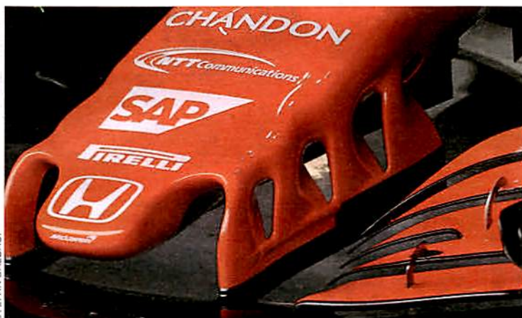
Durch die Schlitzte klebt die Strömung enger an der McLaren-Nase
