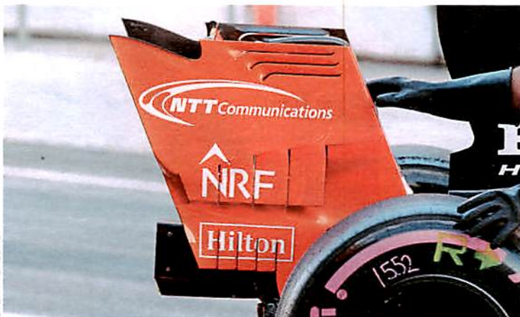
Der Lamellen-Vorhang zieht den McLaren-Heckflügel künstlich nach außen
