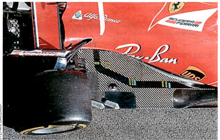
Technik-Geheimnis: Ferrari zieht seltsame Kanäle durch den Unterboden
