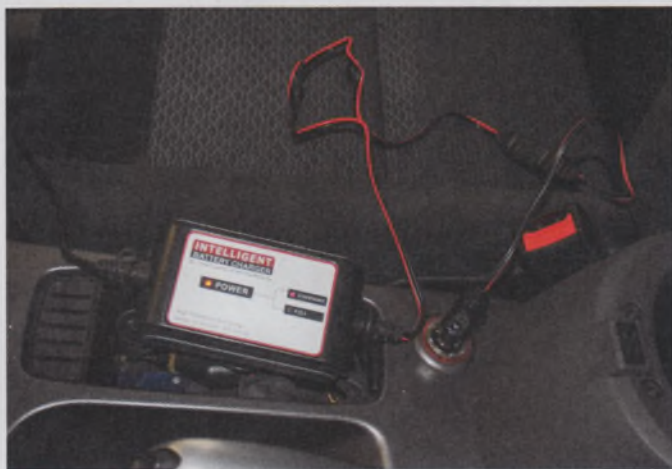
Kényelmes töltés az utastérből, a szivargyújtó aljzatán keresztül
