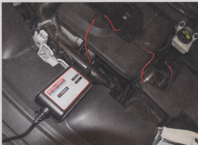
Kábeles töltésnél a fix csatlakozó stabilabb kapcsolatot biztosít
