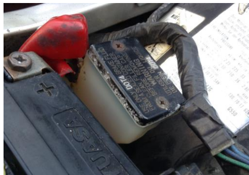
Het achterrem-reservoir. Deze zit onder het zadel achter de accu.
