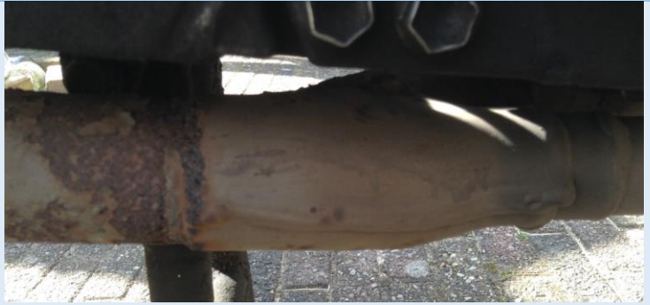
Redelijk geconserveerd Y-stuk. Let vooral op de delen bij de lasnaden, deze roesten het hardst.
