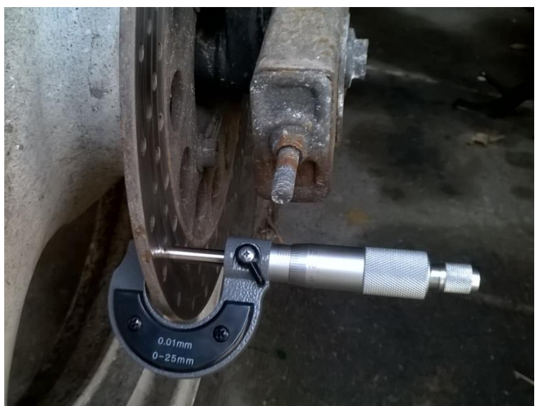
Meet de remschijven altijd op het dunste punt. De schijf is aan de rand dikker dus je zal een beugel-meter moeten gebruiken. Meet op een deel dat vrij is van roest.
