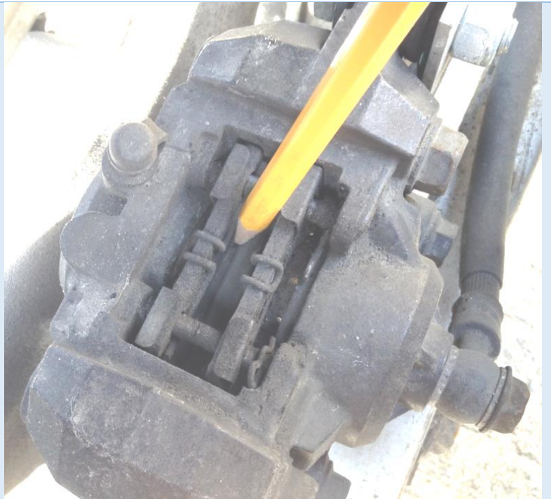
Remvoering zichtbaar bij de potloodpunt.
