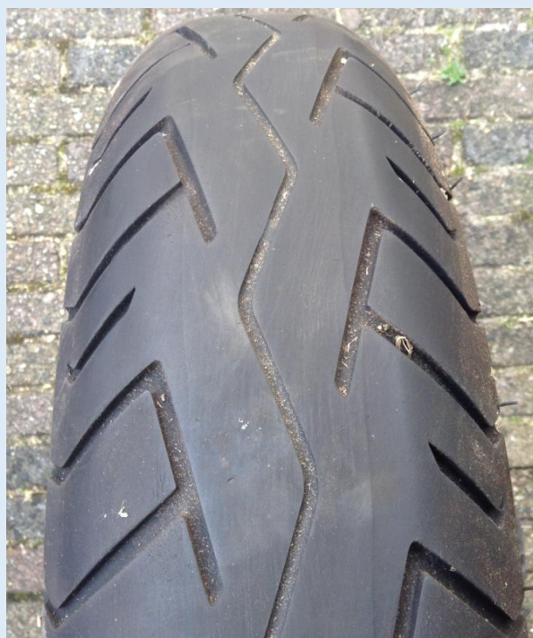
Een versleten achterband. 'Vierkant' afgesleten (weinig bochten gemaakt) omdat het profiel aan de zijkant nog dik aanwezig is.
