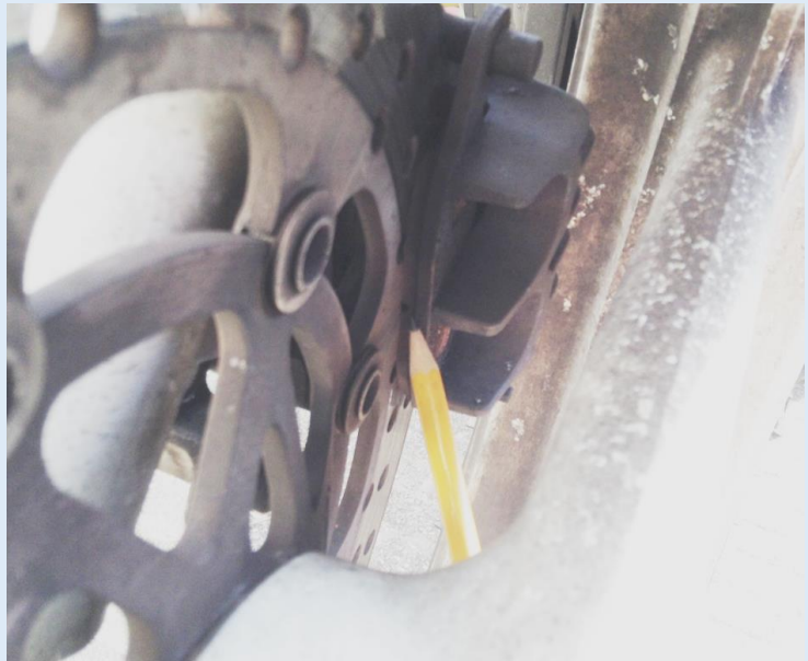
Dikte van de voorrem blokken zijn goed te zien vanaf de linker kant van de motor. Als je door het voorwiel heen kijkt kan je de voering goed zien.
