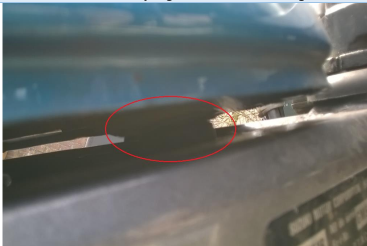
Het rubber is aanwezig en de tank zit stevig vast.
