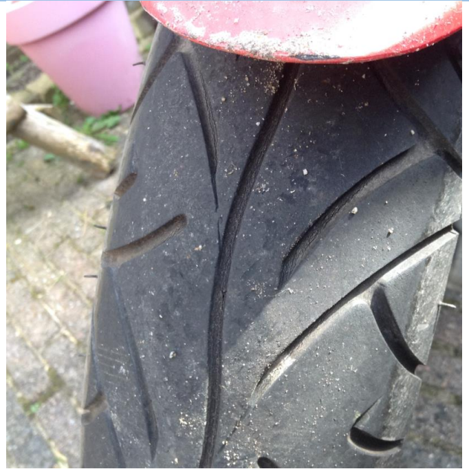
Uitgedroogde band met veel scheuren in het profiel
