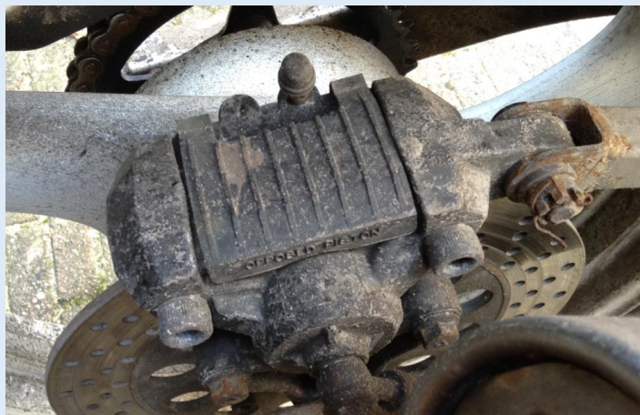
De achterrem is voorzien van een plastic kapje. Deze kan je er makkelijk af klikken om de blokken te bekijken:
