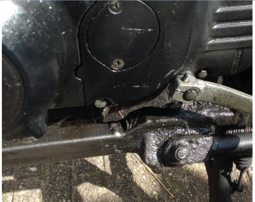
Veel (erg natte) smeer bij de zijstandaard en schakelas. Hier lekt waarschijnlijk ook iets (let op: kan ook gewoon smeer van de ketting zijn!)
