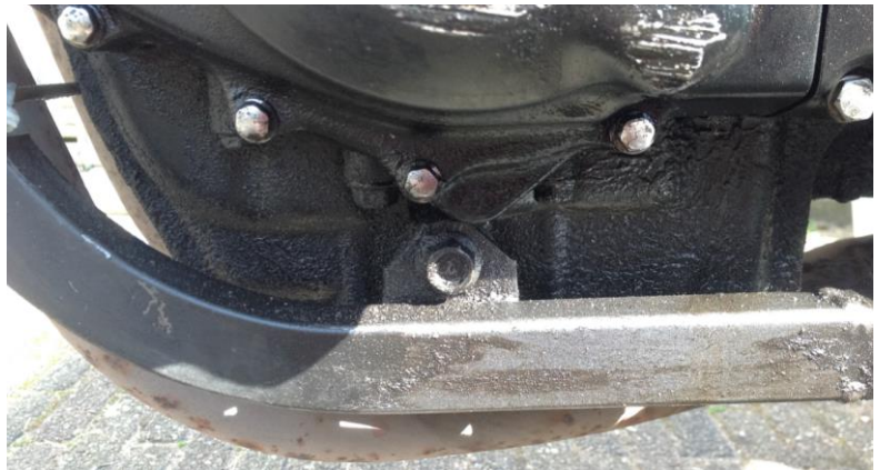
Smeer aan de onderkant van het motorblok. Hier lekt iets.
