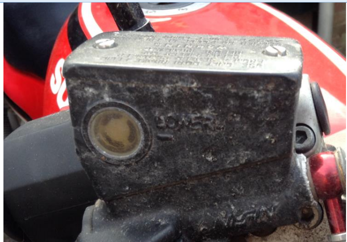
Een vol reservoir met schone remvloeistof
