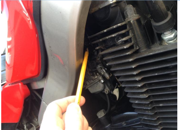
Het choke mechanisme is zichtbaar vanaf de rechter kant van de motor. Om het eind van de chokelkabel zit een veertje.
