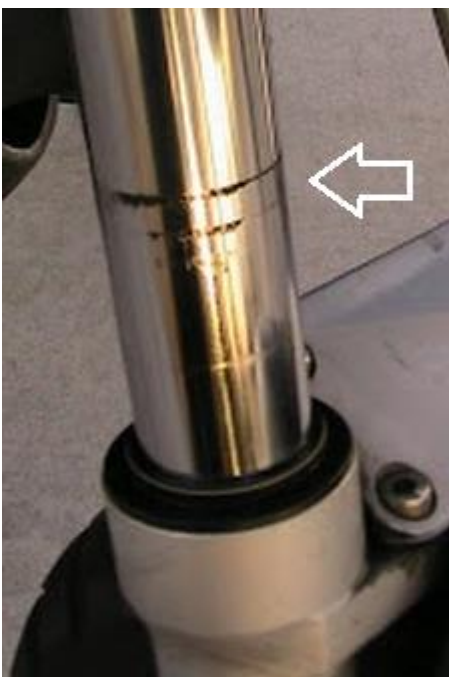
Vette strepen boven het deel waar de poot beweegt betekend ook lekkage
