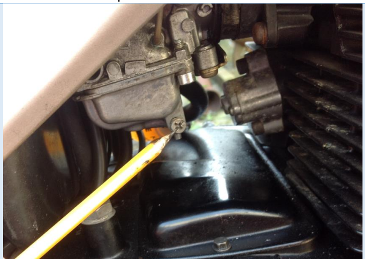
De vlotterkamer aftap schroef (op beide carburateurs). De aftap nippel zit eronder.
