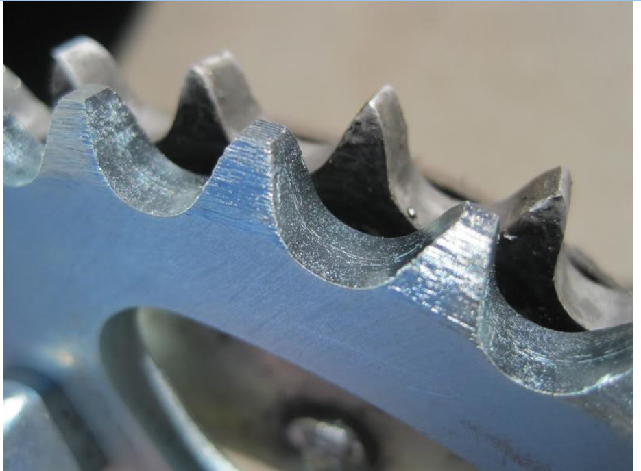
Vooraan een goed ketting wiel, daarachter een versleten ketting wiel. Let op de puntigheid van de tanden.
