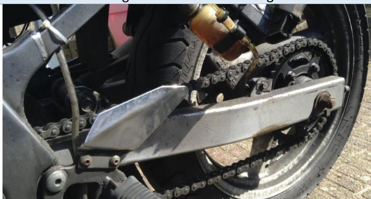
Geen kettingbeschermer aanwezig: Niet ok.
