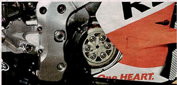
Honda von Dani Pedrosa mit der älteren, schwereren Kupplung
