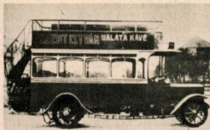
Ezt a tömör arbronsú, csúszásgátló szekkel ellátott Ganz-Büssing gyártmányt —, amelynek adatai nagyjából szintén megegyeztek a korábbiakkal — 1917-ben ismerték meg a pestiek
