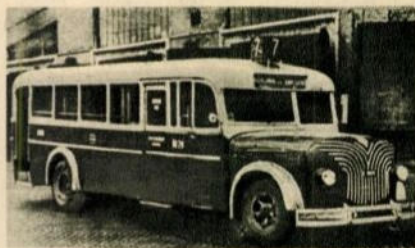
Bizonyára sokak számára emlékezetes még a MÁVAG N 26/38 típus. Az 1938-ban üzembe helyezték, 90 lóerős, OML—67 jelű motorral szerelt buszok a „harcosa” nevet kapták a pestiektől
