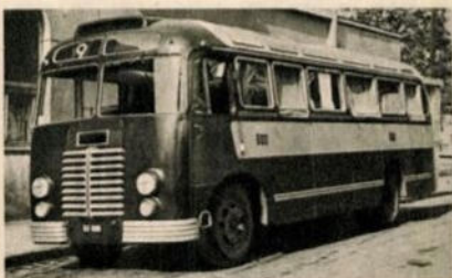
Az első önhordó-karosszériás Ikarus—30 típus 1951. június 15-én jelent meg a fővárosi forgalomban. Sok budapesti, majd sok-sok vidéki utas emlékezhet még rá
