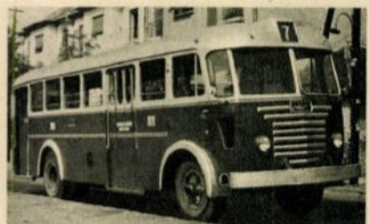
Mint erős, sokat kibíró járművet ismerjük, 1952 óta az Ikarus gyár 60-as típusait, amelyek átalakítva csuklós járművekké ma is segítik a közlekedést
