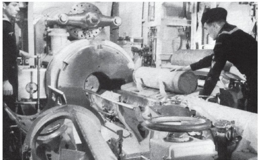
▲ Manutention de charges propulsives de 28 cm sur le Gneisenau . Les gargousses sont ici déplacées sur des glissières de la salle de transbordement, contiguë à la soute correspondante, et par l'orifice visible sur la cloison au fond, transférées dans le puits de tourelle, où elles seront déposées dans les bennes des ascenseurs à munitions.
