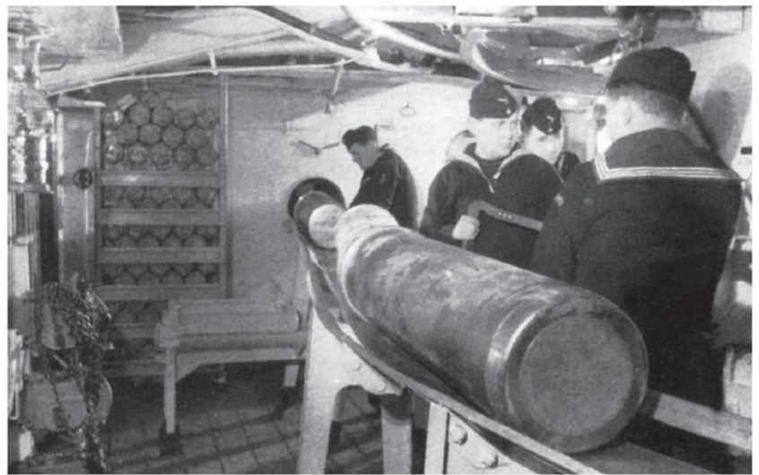
▲ Manutention de charges propulsives de 28 cm sur le Gneisenau . Les gargousses sont ici déplacées sur des glissières de la salle de transbordement, contiguë à la soute correspondante, et par l'orifice visible sur la cloison au fond, transférées dans le puits de tourelle, où elles seront déposées dans les bennes des ascenseurs à munitions.
