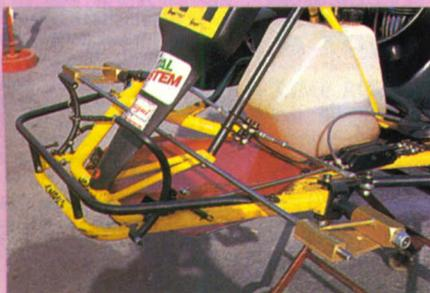
A seconda di come si posiziona lo strumento si può controllare la convergenza delle ruote, sopra, oppure il camber, sotto
