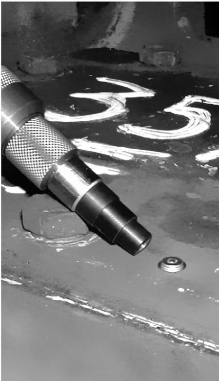
L'obiettivo del sistema di etichettatura SmartPoint® è quello di tracciare i componenti in modo che le informazioni permangano nel tempo e siano facilmente accessibili. Per ogni componente sono riportati: numero di serie (Serial Number), numero del particolare (Part Number), data e ora in cui è stata effettuata la manutenzione, matricola dell'operatore che ha eseguito la manutenzione ed un campo note in cui riportare l'ultimo evento manutentivo realizzato.
