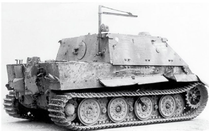
▲ Sturmmörser (châssis 250 471) de la Kp. 1001 , récupéré par les troupes britanniques. La photo met bien en évidence la fixation par pattes boulonnées de la casemate, sur les flancs de la caisse de Tiger I. Archives Caractère
