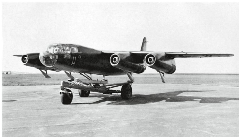
Ces 3 photos et page de droite, en haut : Le quadriréacteur Ar 234 V6, WNr. 130006, Skz GK+IW, à moteurs BMW 003 A-0, vu sous différents angles et tracté à la force humaine vers son aire de point fixe avant le décollage. La dernière photo montre le démarrage d'un des moteurs via un moteur auxiliaire externe.
