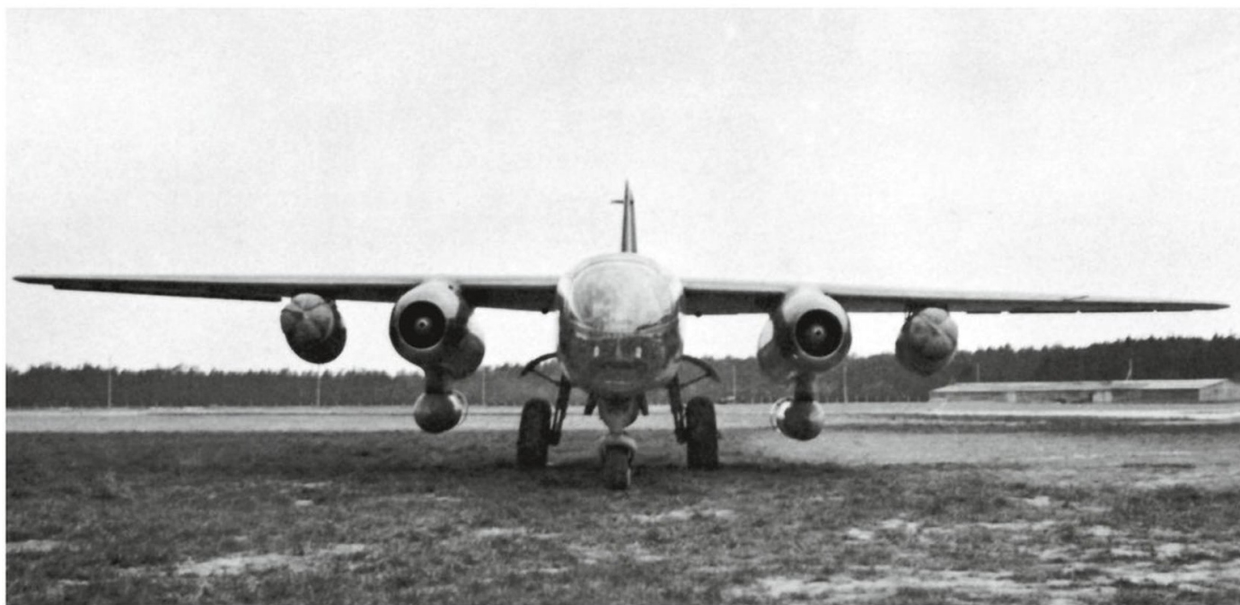
Ces 3 photos : L'Arado Ar 234 V9, qui sert à la définition de la série B, est vu avec différentes charges de bombes ou de réservoirs supplémentaires de carburant, voire d'une combinaison des deux.
