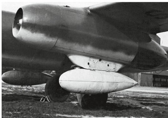
► Vues de l'Arado Ar 234 V9, WNr 130009, PH+SQ avec, à gauche, une bombe SC 500 ventrale et une sous nacelle de réacteur et, à droite, un réservoir supplémentaire de 300 litres de carburant sous chaque nacelle.
