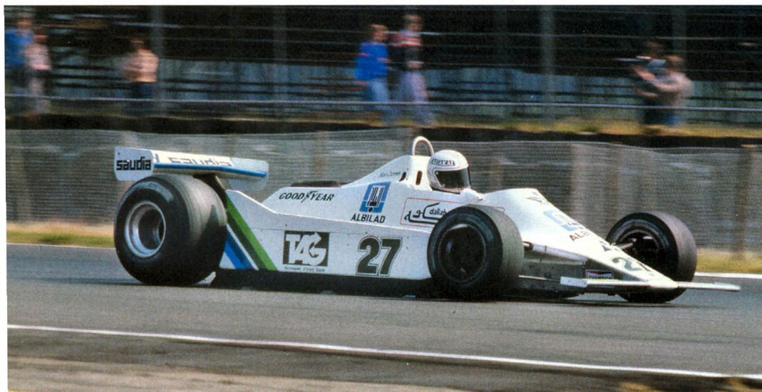
Brtvljenje rupe u podnici oko motora omogućilo je Williamsu fantastične rezultate i nadmoć čak i u odnosu na bolide s turbopunjačima. Jones (na fotografiji) je odustao od utrke na Silverstoneu 1979. zbog kvara crpke za vodu, no Regazzoni je ipak Williamsu donio prvu pobjedu
