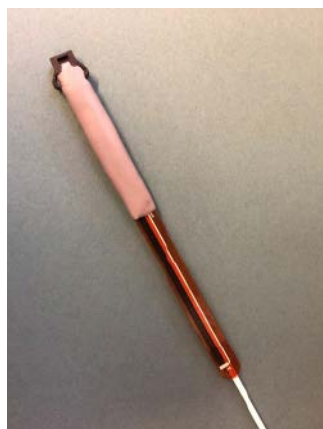
Fotografia 3. Za pomocą masy Sugru uformowano wokół podstawy czujnika, paska i wtyczki wzmacniający element
