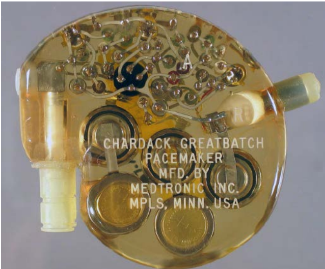
Fotografia 16. Rozrusznik Chardack-Greatbatch wykonany w obudowie żywicznej, w technologii pośredniej – „ścieżki” wykonano w postaci wyprofilowanych blaszek, łączących poszczególne komponenty ( https://t.ly/ykKh )
