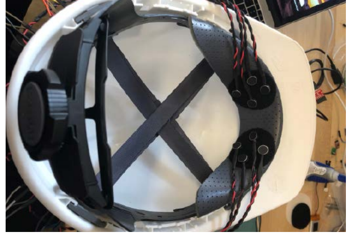
Fotografia 7. Efekторы haptyczne zamontowane po wewnętrznej stronie kasku
