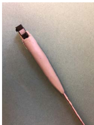
Fotografia 3. Za pomocą masy Sugru uformowano wokół podstawy czujnika, paska i wtyczki wzmacniający element
