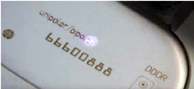
Fotografia 18. Znakowanie laserowe obudowy implantu ( https://t.ly/oaf7 )
