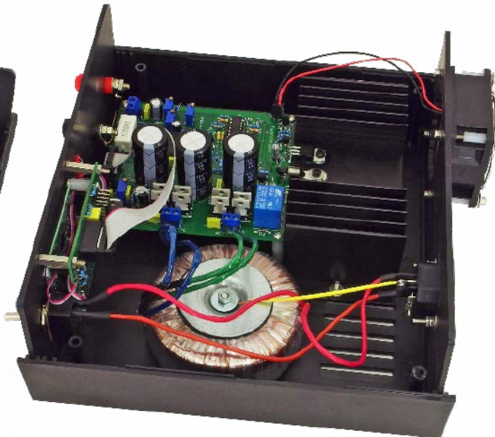
Fotografia 6. Wygląd wnętrza zasilacza pokazujący podzespoły osadzone na płycie tylnej i płycie przedniej oraz sposób montażu podzespołów na spodzie obudowy
