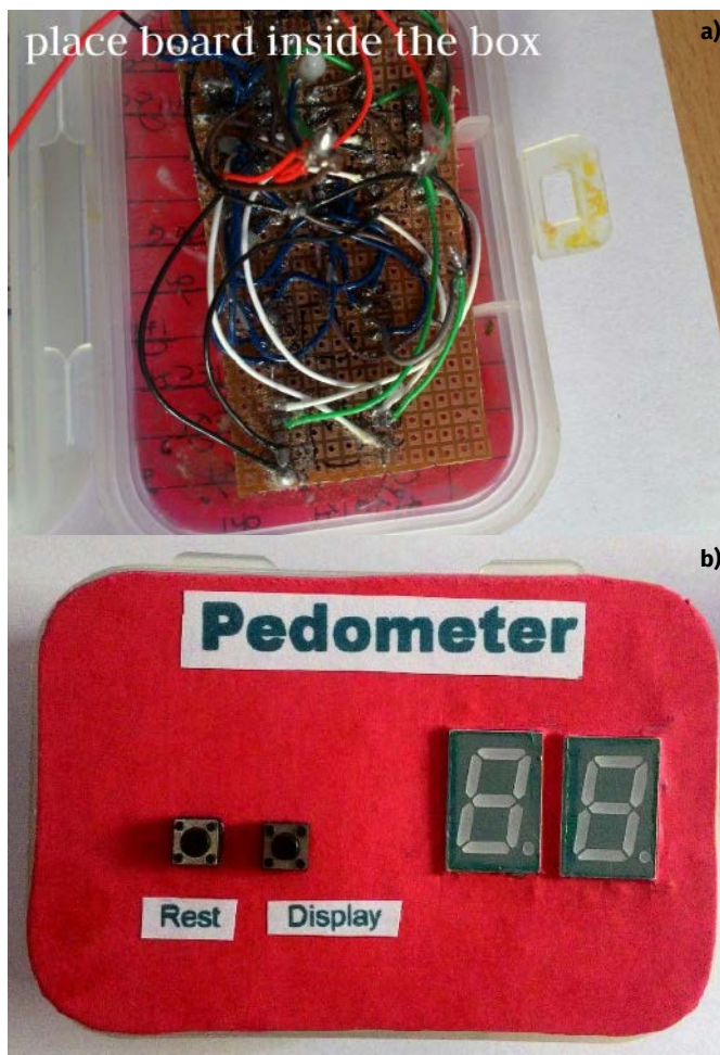
Fotografia 5. Pedometr na licznikach CD4026; a) uniwersalna płytka drukowana z elementami; b) układ w obudowie
