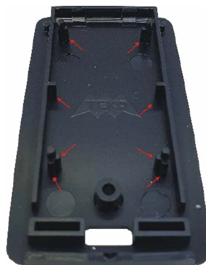
Fotografia 3. Wygląd wnętrza dolnej części obudowy z zaznaczeniem nadlewek przeznaczonych do usunięcia
