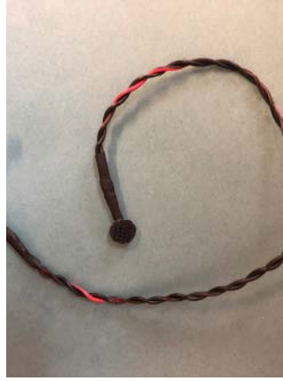
Fotografia 6. Silnik wibracyjny przygotowany do zamontowania w kasku
