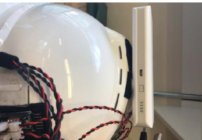
Fotografia 8. Akumulator zamontowany w górnej części kasku
