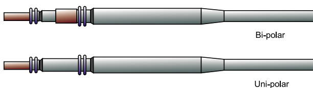
Rysunek 13. Porównanie konstrukcji złączy IS-1 Bi (na górze) i IS-1 Uni (na dole). Czerwone elementy oznaczają pola stykowe, niebieskie – uszczelnienia, pozostała część to izolacja przewodu oraz złącza (https://t.ly/nwUq)
