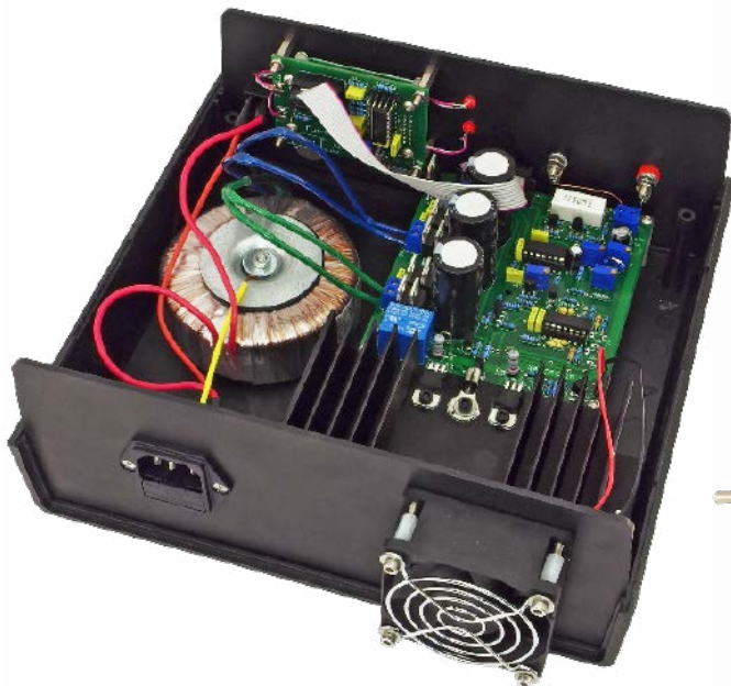
Fotografia 5. Wygląd wnętrza zasilacza pokazujący podzespoły osadzone na płycie tylnej i płycie przedniej oraz sposób zamontowania elementów do radiatora
