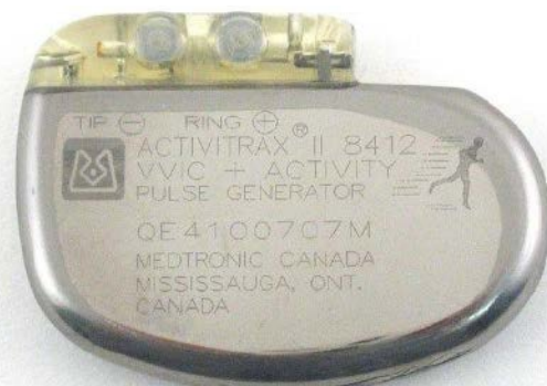
Fotografia 19. Pierwszy rozrusznik dostosowujący częstotliwość generatora do aktywności ruchowej pacjenta – model Activitrax marki Medtronic. Uwagę zwracają niewielkie wymiary urządzenia, pomimo zaimplementowania w nim dodatkowej funkcjonalności (60×43×12 mm). Źródło: https://t.ly/_Be
