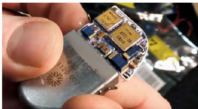
Fotografia 15. Wnętrze rozrusznika po usunięciu tytanowej obudowy. Elektronika wykonana w technologii SMD ( https://t.ly/VZA- )
