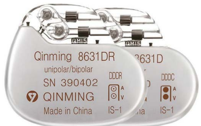
Fotografia 2. Chińskie rozruszniki dwujamowe typu DDDR oraz DDDC ( https://t.ly/4Ghf )
