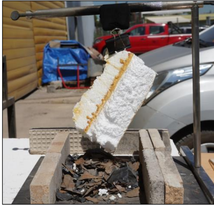
Figura 36: Montaje de canaleta con basura (recuperada en inspección) y porción del techo
