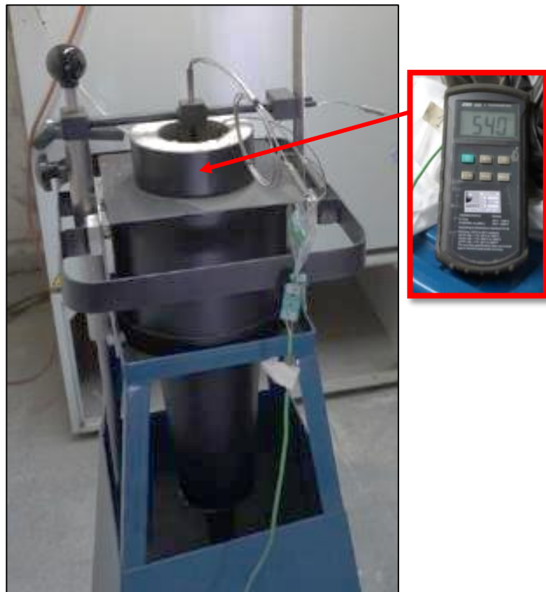
Figura 35: Horno de combustibilidad ISO 1180 y medición de temperatura en cuerpo caliente
