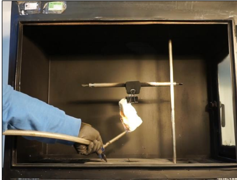
Figura 42: Ignición del EPS en prueba experimental en Laboratorio IPF de DICTUC
