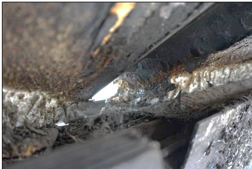
Figura 31: Poliestireno Expandido quemado, con origen del fuego en la canaleta y propagación como se muestra en Figura 30
