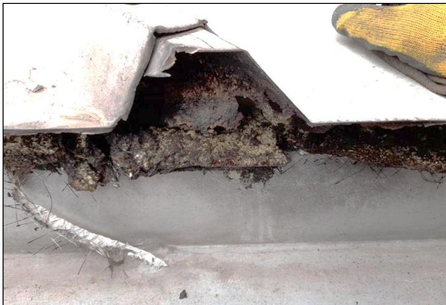
Figura 27: Elemento en Poliestireno Expandido (EPS) quemado desde el exterior
