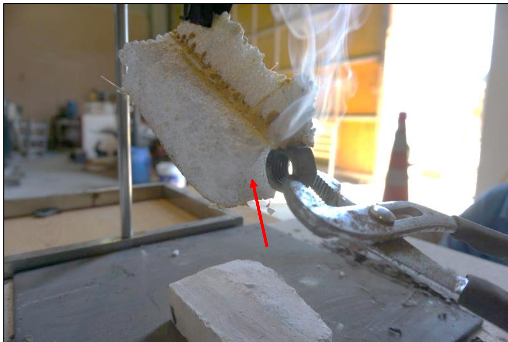
Figura 33: Prueba en laboratorio IPF de DICTUC. Muestra de poliestireno expandido tomada del sitio del siniestro, expuesta o en contacto con cuerpo caliente
