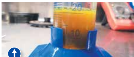
Масло после химической реакции с влагой. Гидрирование масла, понижение значения pH до уровня кислоты
