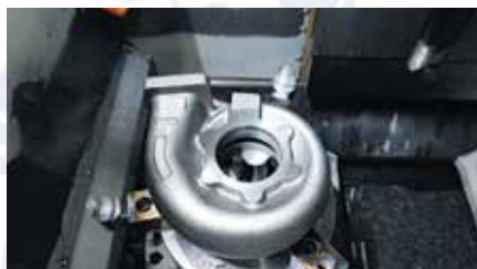
Точная балансировка картриджа (CHRA)
