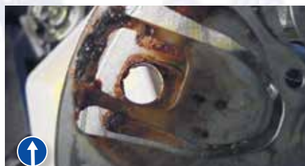
Ржавая компрессорная плита после попадания влаги
