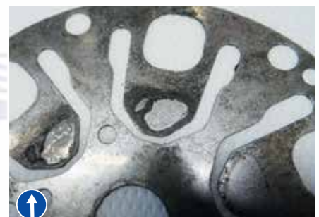
Подгоревшее компрессорное масло в результате перегрева компрессора
