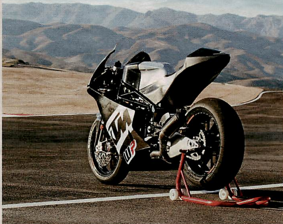
KTM-WP-Moto2: Nach Konzernphilosophie mit Gitterrohrrahmen und WP-Federelementen
