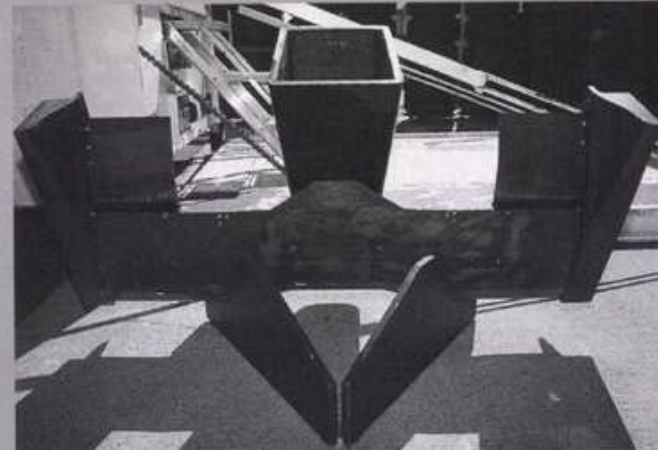
ウイング中央に付いた台形の部分がエクステンション。左右のフラップも小さなタイプに変更
