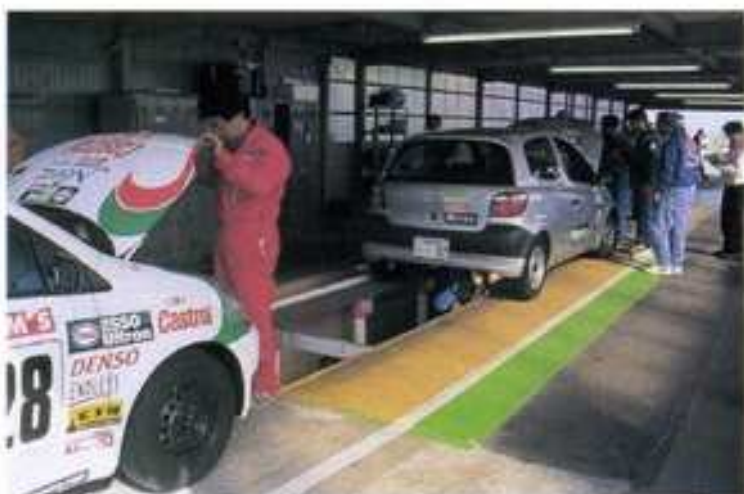
後車検も重要項目。一般車の車検同様の検査を受けることとなるが、素人がマシンに触れてきたためボルトの緩みや冷却水不足などが指摘される場面も
