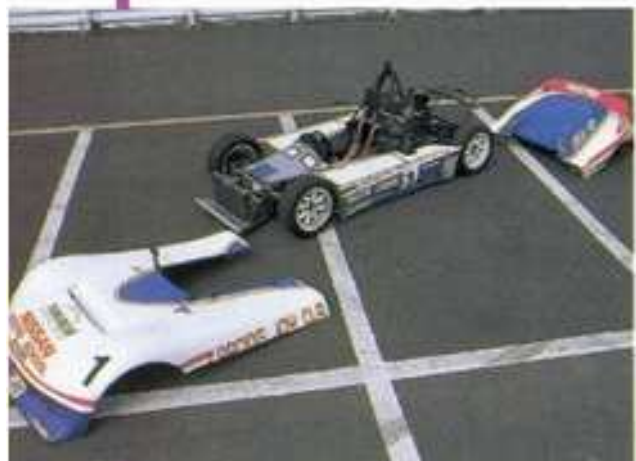
こうしてカウルを外すと、小さいながらもザウルスJrが本格的レーシングカーだと分かるだろう
