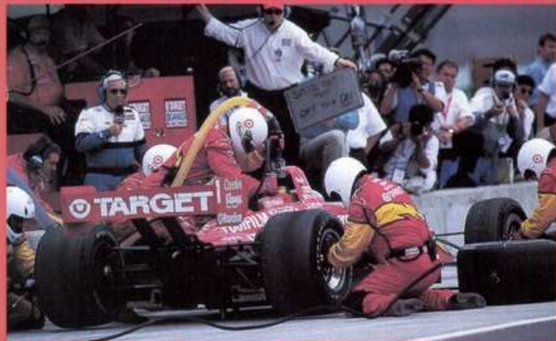
これが問題の最後のピットストップ。黒いホースがポップオフバルブに引っかかっているのが分かる
