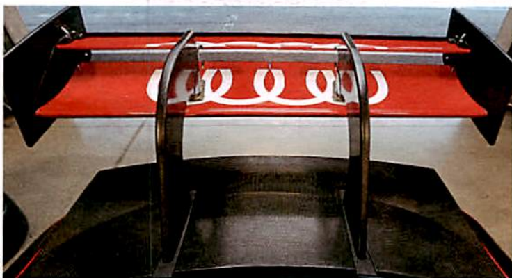
DRS à la F1: Der Klappflügel ist passé. Jetzt schwingt der Flap nach oben
