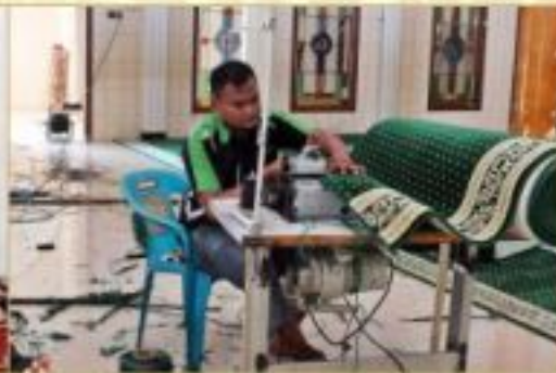
Proses obras dengan mesih khusus
