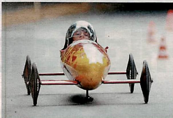
Richtig futuristisch: Gut zu sehen ist die Stempelbremse (unten)
