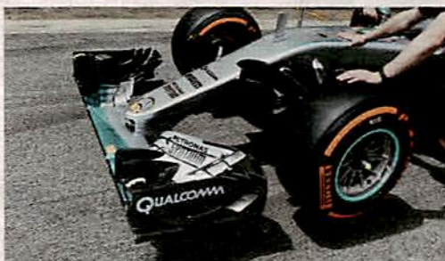
Mercedes: Neuer Frontflügel und spitzere Nase
