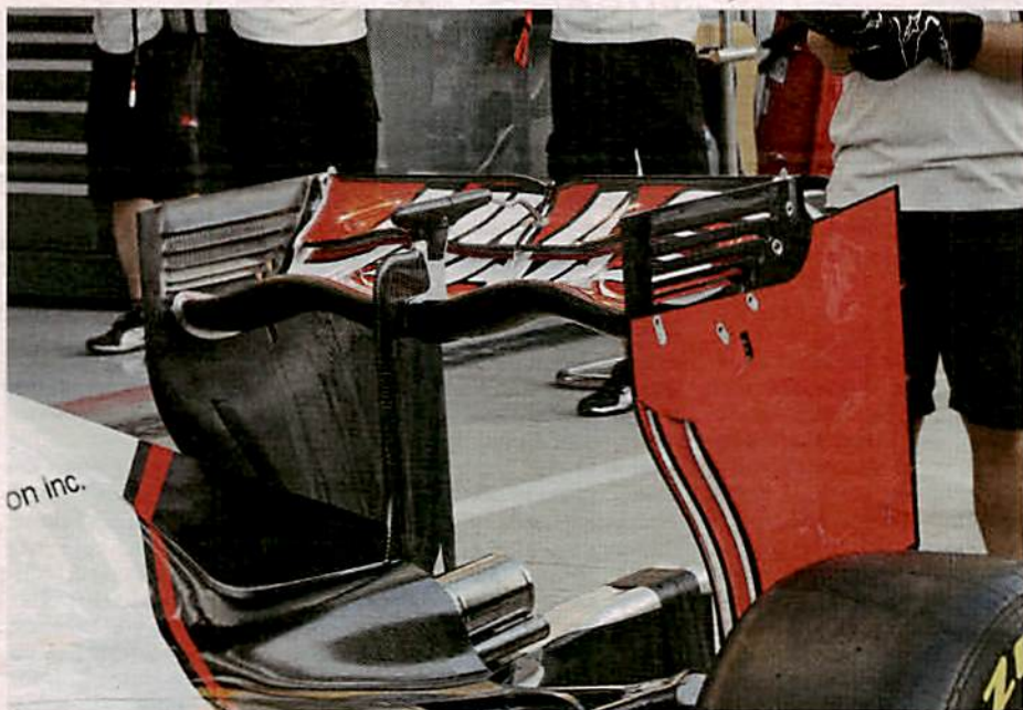
HaasF1: Der Neuling aus den USA brachte einen innovativen Wellen-Heckflügel nach Monza
