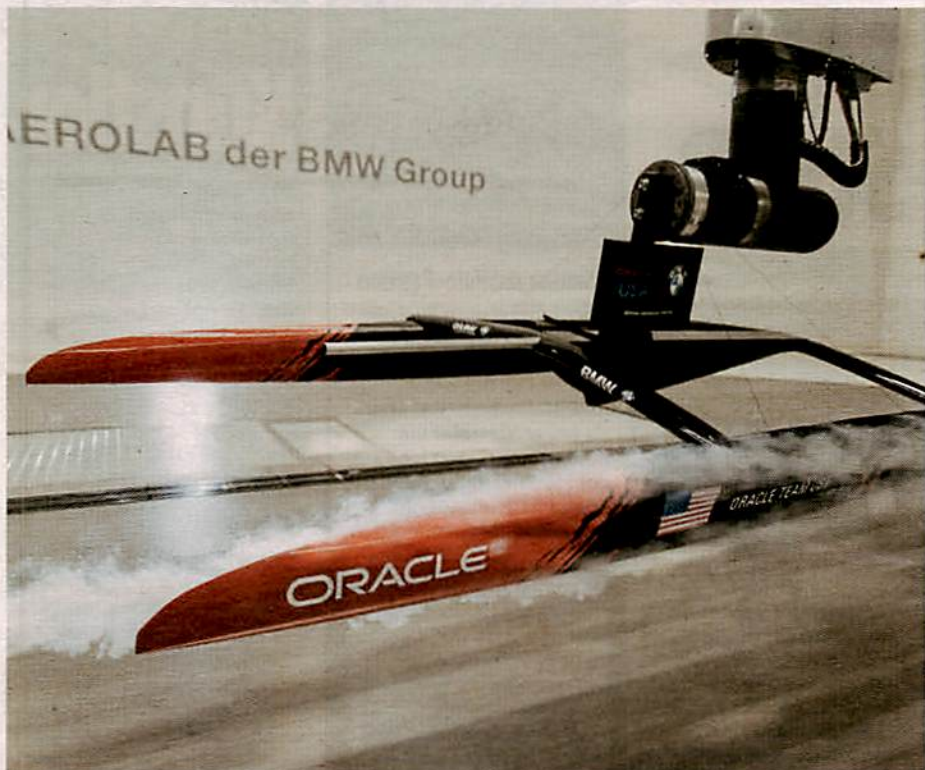
Steht der Formel 1 in nichts nach: Das BMW-Boot «Oracle» wird im Windkanal laufend verbessert
