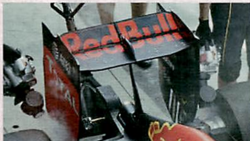
Red Bull: Ganz flacher Heckflügel ohne Schlitz
