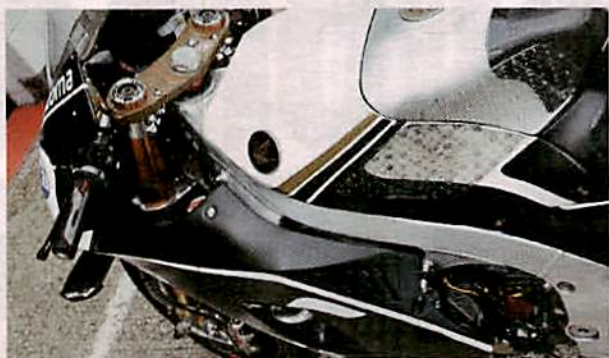
LCR-Honda von Cal Crutchlow mit grazileren Rahmenhauptprofil
