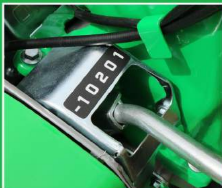
Menjač sa 2 brzine napred i brzinom u nazad
