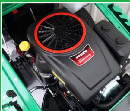
Snažan motor zapremine 432cm 3 , snage 15 KS
