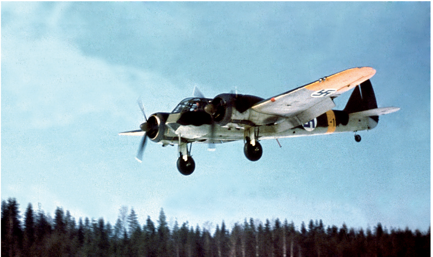
▼ Bristol Blenheim Mk. I atterrissant sur la piste du lac Luonetjärvi en mars 1944. Les Finlandais ont le temps d'en acquérir 18 exemplaires avant la guerre, de même que la licence de production.
