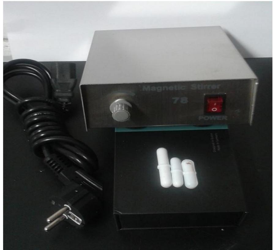
1400 Rpm - 150mm di piano lavorazione – fino a 1 litro
