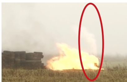
Test di incendio di un veicolo LNG (fiammata nella parte superiore)
