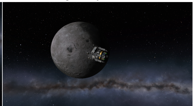
Après 62 h de transfert, LRP arrive à proximité de la Lune. Correction de trajectoire de 4 m/s pour monter le périastre à 15 km.
