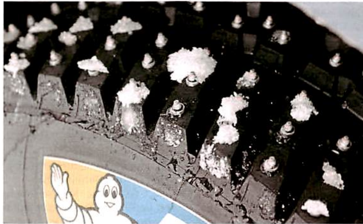
Michelin-Spikereifen: 384 Stahlstifte krallen sich ins Eis
