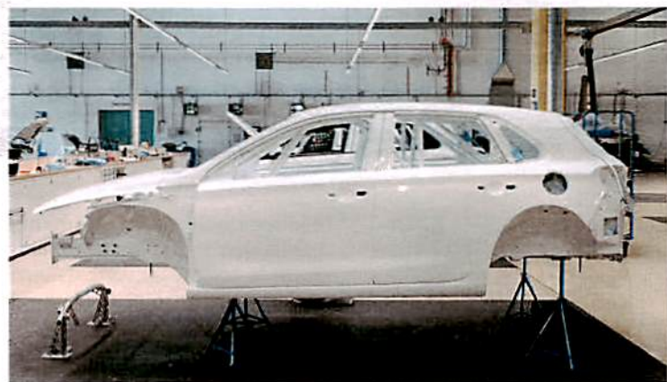
Die Basis: Rohkarosserie des Hyundai i30 N TCR mit Sicherheitszelle
