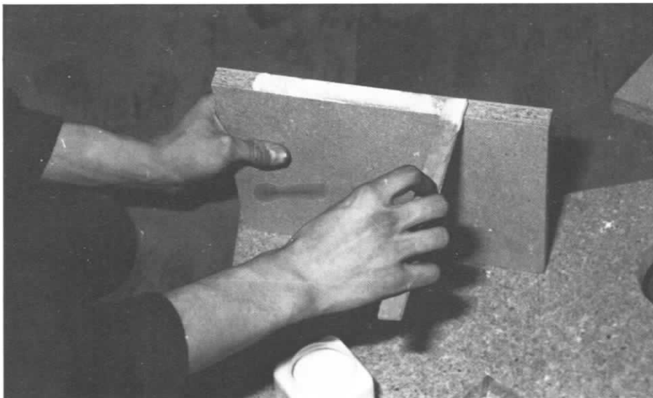
"Samedi 16h 30. Je ne lésine pas sur la colle blanche : je tiens à obtenir une bonne étanchéité et un minimum de vibrations de la caisse dans les graves".
