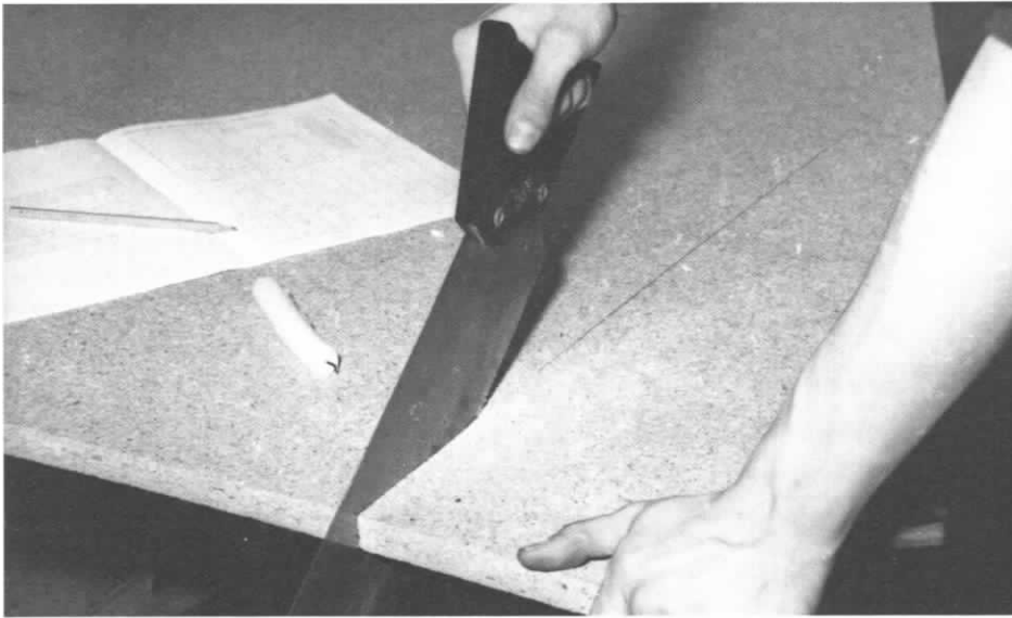
"Samedi 10h. Faute d'une scie circulaire, je découpe mon panneau d'agglom à la scie égoïne".
