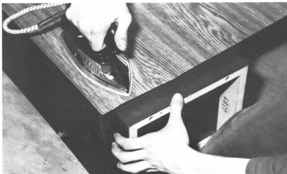
"Dimanche 14h. J'ai préféré opérer un plaquage à chaud. Facile. Le plus délicat a été d'obtenir qu'on me laisse utiliser le fer à repasser".
