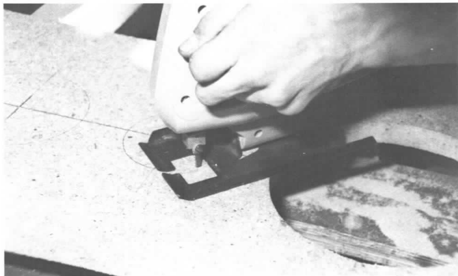
"Samedi 14h 30. Je me concentre sur la découpe des trous des H.P. avec ma scie sauteuse".
