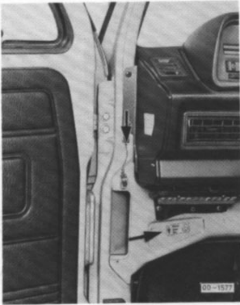
1 Säule I Türkontaktschalter aus- und einbauen.
