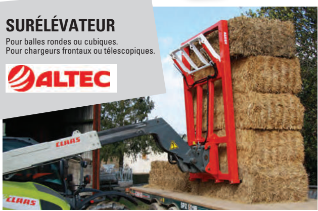
M44MC : 4 dents droites + 1 griffe articulée. Nécessite un seul double effet. Capacité 2 200 kg
