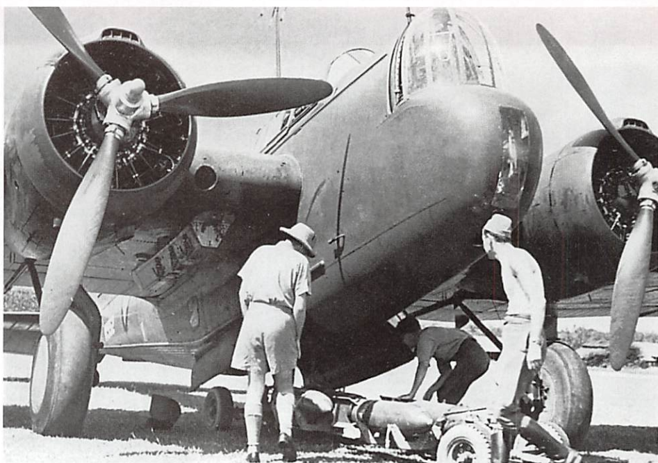
Chargement d'un WH-3. Cette version ne se distinguait par seulement par sa longue verrière. Le «menton», sous la tourelle avant, était moins pointu.
