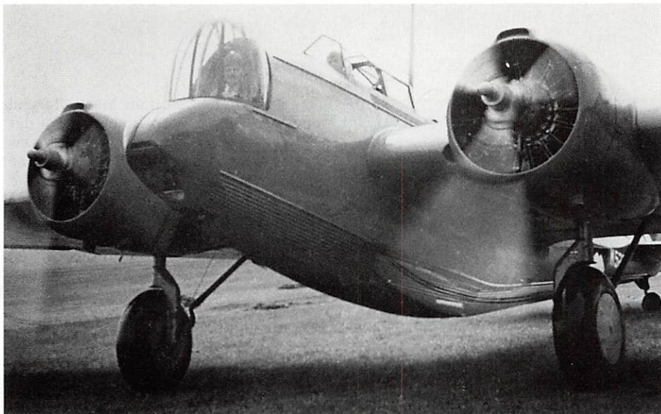
Haut et étroit, le fuselage du Martin 139 était dessiné autour de la silhouette d'un homme vu de face, avec une section minimale pour limiter la traînée.
