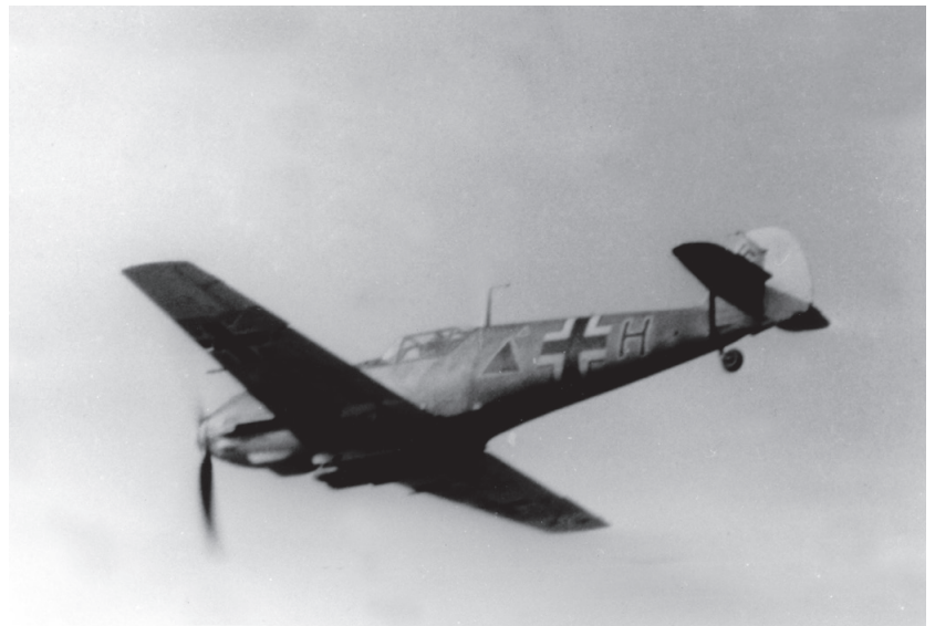
▼ Le Messerschmitt Bf 109 E-4/B « H noir » de la 5.(S)/LG 2 durant la bataille d'Angleterre. Le triangle peint sur le fuselage est celui des Schlachtgruppen auxquelles s'apparente le groupe. L'appareil est armé de quatre bombes de 50 kg. © ECPAD/France/1940/ Photographie inconnue
