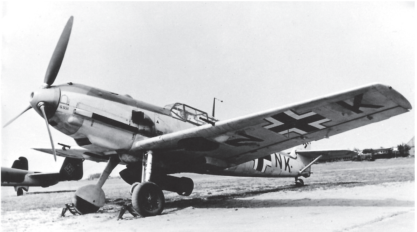
▼ Le prototype du Messerschmitt Bf 109 E Jabo pourvu du râtelier ETC 500 affectant une bombe de 250 kg. (Sauf mention contraire, toutes photos coll. C. Goss)
