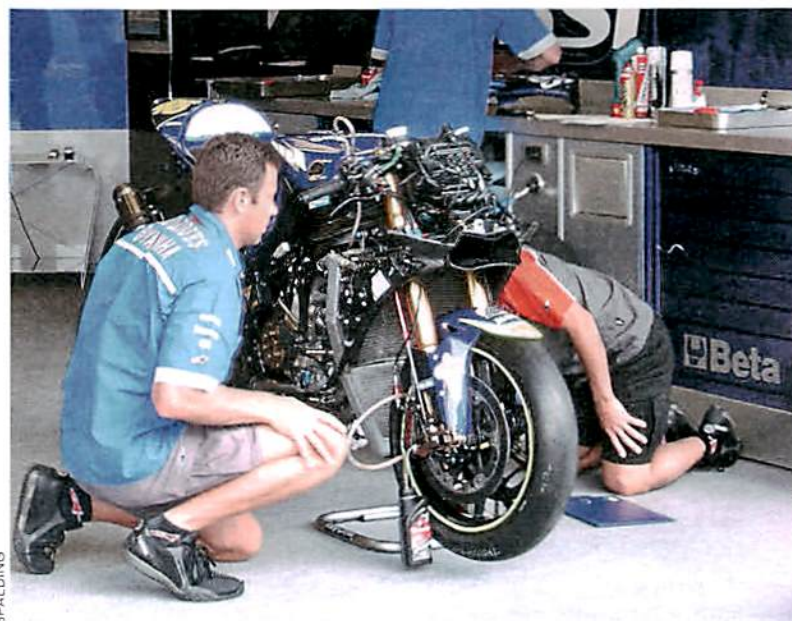
2004: Gut zu sehen ist der lange vordere Ausleger der vorderen Motoraufhängung
