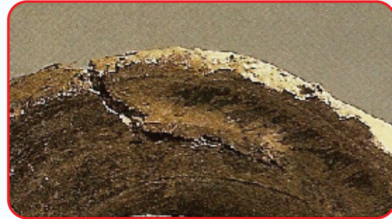
شكل ( ٥٢ ): يوضح نتائج أخطاء التجفيف ( تشقق ).
